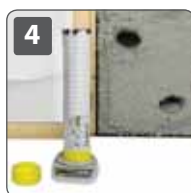
4 Mesure de la densité d'insufflation avec le kit de contrôle de densité NW100
