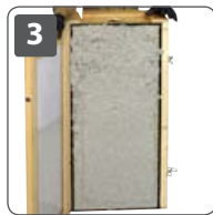
3 Öffnen des Prüfelement und begutachten des Befüllergebnisses
