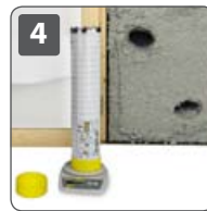
4 Dichteproofung am befüllten Prüfelement mit Dichteproofset NW100
