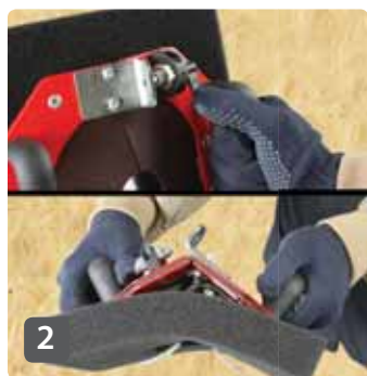
2 Ouvrir la barre d'arrêt et replier le passage de tuyau
