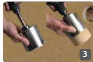
Bohrkern mit Hilfe des Auswurfsystems rausschieben
