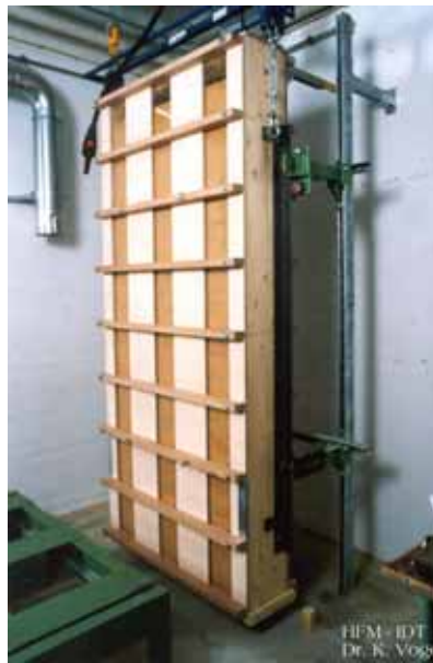
Abbildung 14: Versuchseinrichtung zur Durchführung von Setzungsversuchen mit Wandbauteilen.
