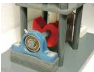
Abbildung 10: Messgerät zur Ermittlung des Setzungsverhaltens im Kleinversuch. Ein mit Motor betriebener Exzenter hebt das Prüfgefäß in einer Führung senkrecht um 33 mm an und lässt es dann im freien Fall auf eine harte Auflage aufschlagen.
