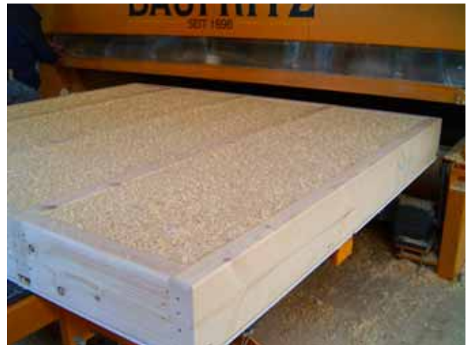
Abbildung 22: Auslauf der gefüllten Wandbauteile.
