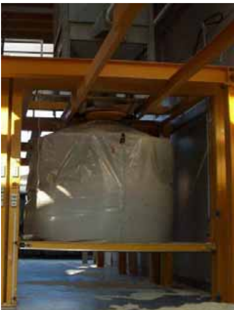
Abbildung 20: Befüllstation für Feinteile; Hubboden zum Anformen der ebenen Standfläche hochfahren.
