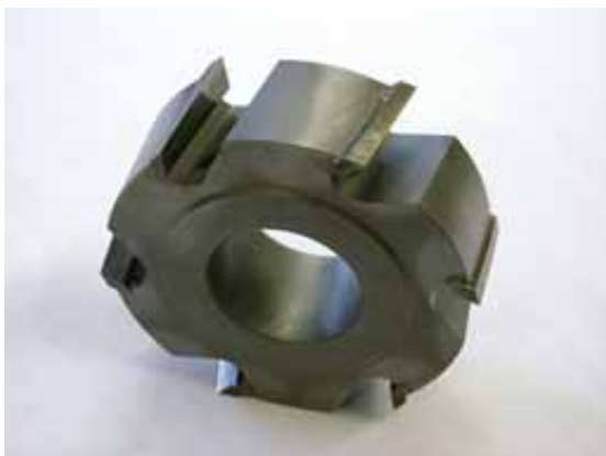
Abbildung 16: Werkzeug mit optimierten Werkzeugkenngrößen wie z.B. Freiwinkel \alpha , Keilwinkel \beta , Spanwinkel \gamma , Neigungswinkel \lambda , Einstellwinkel \kappa .
