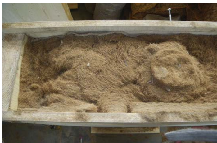
Polyvalent en termes d'isolation : Test de matériau Zellofant M95 avec du jonc de mer
