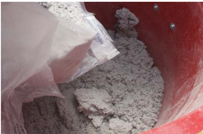
Lors de la mise en œuvre du matériau isolant durable classique qu'est la cellulose
