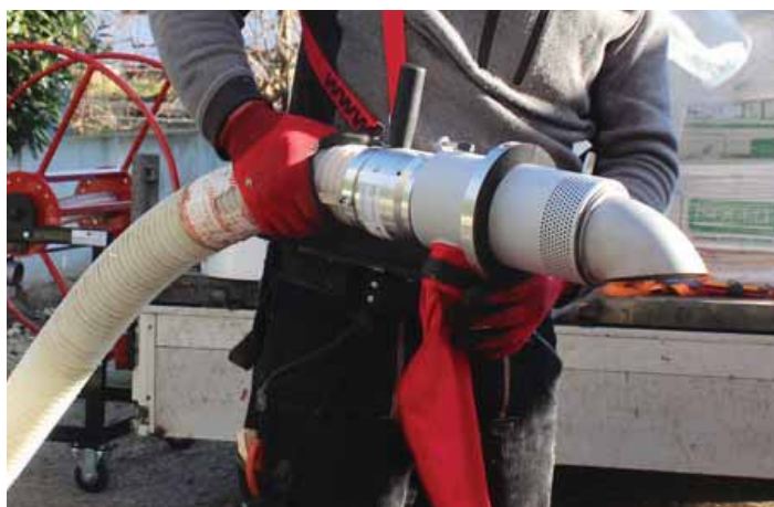
Entlüftete Drehdüse X-Floc J-Jet: Optimiert für hohe Durchsätze
