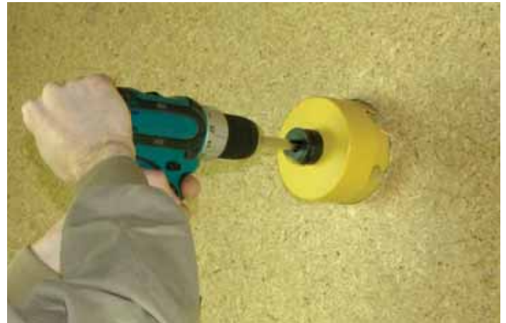
Scie cloche avec éjection pour des ouvertures d'injection dans une multitude de matériaux
