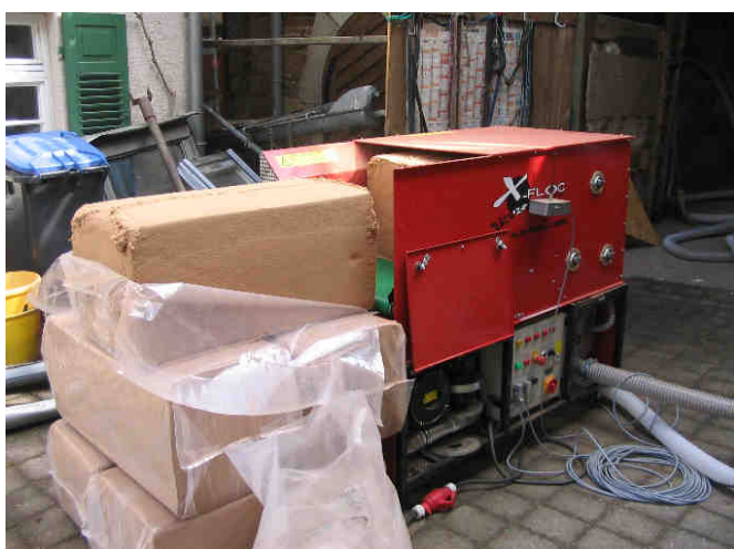
Turbofant M03 bei der Befüllung
