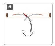
Beispiel: Ständerwand Einblasnadel einführen (1), schwenken (2), herausziehen und nach oben drehen (3) Oberen Bereich mittels Schwenken befüllen (4)
